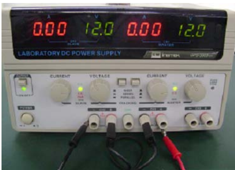
图 1-3-3 GPS-3303C 型直流稳压电源输出正负电压接线图
